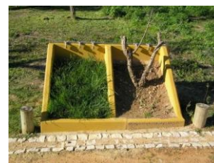
Fig. 2 – Caixas de Erosão
